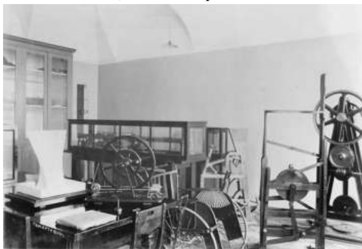
Фотография 1899 года механического кабинета Санкт-Петербургского Университета, запечатлевшая несколько механизмов, созданных П. Л. Чебышевым (из альбома Б. Н. Мениуткина). Справа на переднем плане «велосипед», левее него частично закрыто столом — «самоходное кресло», за креслом на полу стоит «сортировалька». Фото: Музей истории СПбГУ
